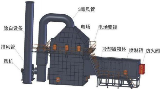
6.2-2 “水喷淋+间接冷却+静电”设备示意图
